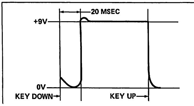
FIGURE 4-4 TRIGGER AT COLLECTOR OF Q8
