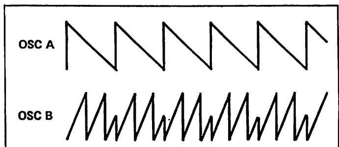
FIGURE 2-3 SYNCHRONIZATION OF OSCILLATOR B TO OSCILLATOR A
